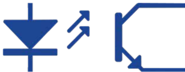
Schaltplan für einen reflektierenden Infrarotsensor
